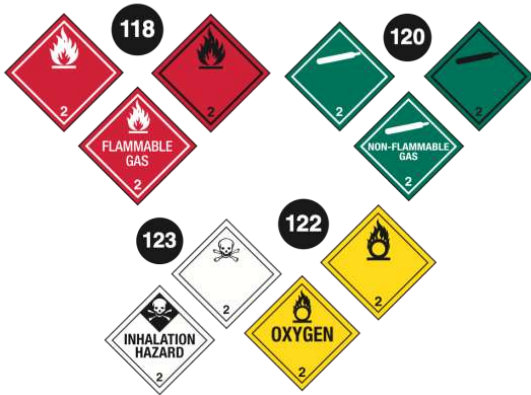
شکل ۶- علامت ایمنی نشان دهنده طبقه ۲ مواد خطرناک، گازها
